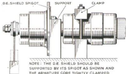
Fig. 87. Testing clutch slip torque.
