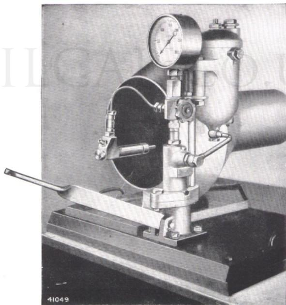
Fig. 70. Injector unit test rig.
