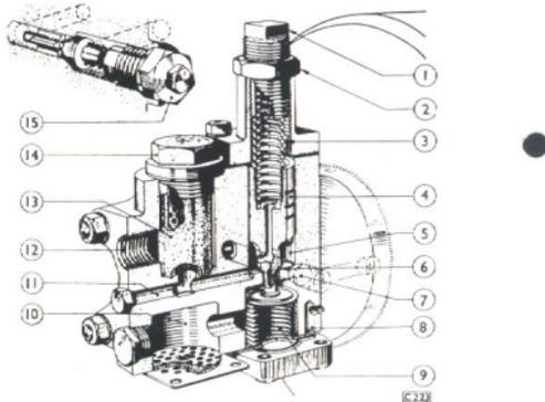
Fig. 7. Unloader valve.
