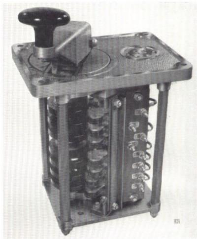
Fig. 14. Throttle controller.
