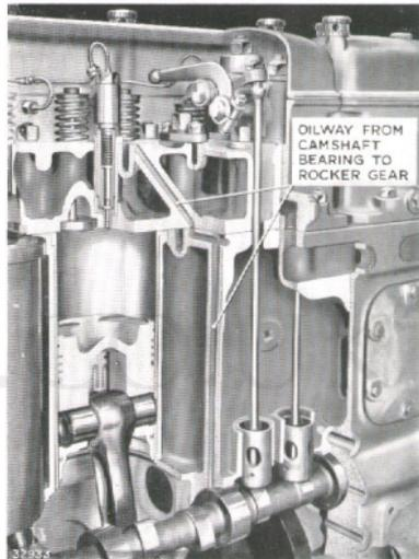
Fig. 9. Rocker gear lubrication (engine in stand).
